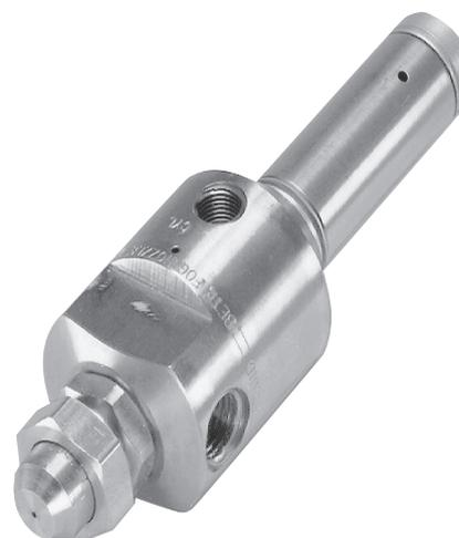
Le XASF est un atomiseur pneumatique à mélange interne, alimentée par siphon. Sa conception en siphon signifie que l'alimentation en fluide n'a pas besoin d'être pressurisée. Ainsi, aucune pompe à fluide n'est nécessaire. Cette conception permet également des débits très faibles, inférieurs à 1 litre par heure. Le XASF peut être utile dans un certain nombre d'applications, notamment :
