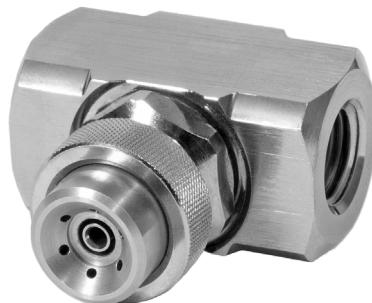
La buse de pulvérisation d'air XAPR produit des pulvérisations finement atomisées en forme de cône complet. La conception du mélange externe signifie qu'elle peut traiter des fluides visqueux et que le contrôle des débits est plus simple qu'avec les variantes à mélange interne. Ces caractéristiques font que la XAPR est le plus souvent utilisée pour :
