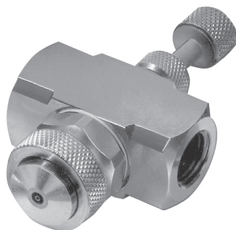
Le XASR est une buse de pulvérisation d'air à mélange interne, alimentée par siphon. Sa conception en siphon signifie que l'alimentation en fluide n'a pas besoin d'être pressurisée. Ainsi, aucune pompe à fluide n'est nécessaire. Cette conception permet également des débits très faibles, inférieurs à 1 litre par heure. Le XASR peut être utile dans un certain nombre d'applications, notamment :
