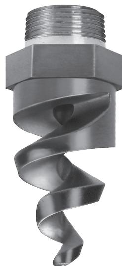
La TFXP est une variante de notre buse à spirale TF standard qui est conçue avec un passage libre extra large. Cela améliore la résistance au colmatage de la conception de la spirale déjà résistante au colmatage. Elle laisse passer des particules de taille égale à la taille de l'orifice indiquée dans la fiche technique ci-dessous.
