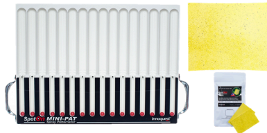
Motif de pulvérisation et répartition des gouttelettes
