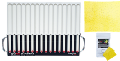
Motif de pulvérisation et répartition des gouttelettes
