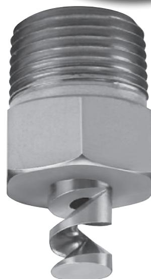
La série L est la variante à faible débit de la buse spirale. Elle produit un jet initial en cône creux qui se transforme rapidement en brouillard à une faible distance de la buse. Elle est utilisée dans un certain nombre d'applications, notamment :
