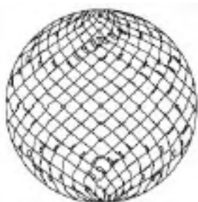
Couverture de deux têtes de lavage
