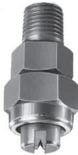
La BJ est une buse à jet plat à faible débit. Elle se compose de trois éléments : une base, une buse de pulvérisation et un écrou de capuchon (avec une crête en option). Les unités de base et les capuchons sont universels, ce qui signifie que les buses de pulvérisation peuvent être interchangées entre les unités de base.
